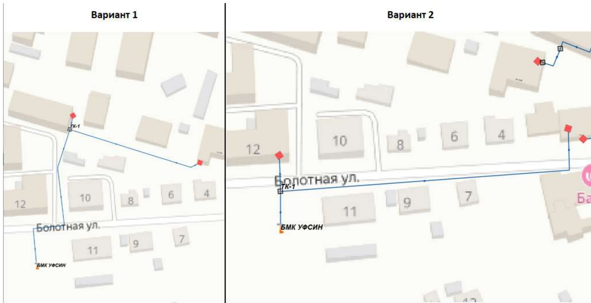
Рис. 4.50. Мероприятия по Сценарию 1 (2 варианта подключения)
