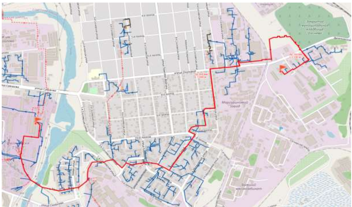
Рис. 3.2. Путь для построения пьезометрического графика участка тепловой сети от ИвТЭЦ-2 в зону действия котельной по адресу г. Иваново, ул. Окуловой, 74Б
