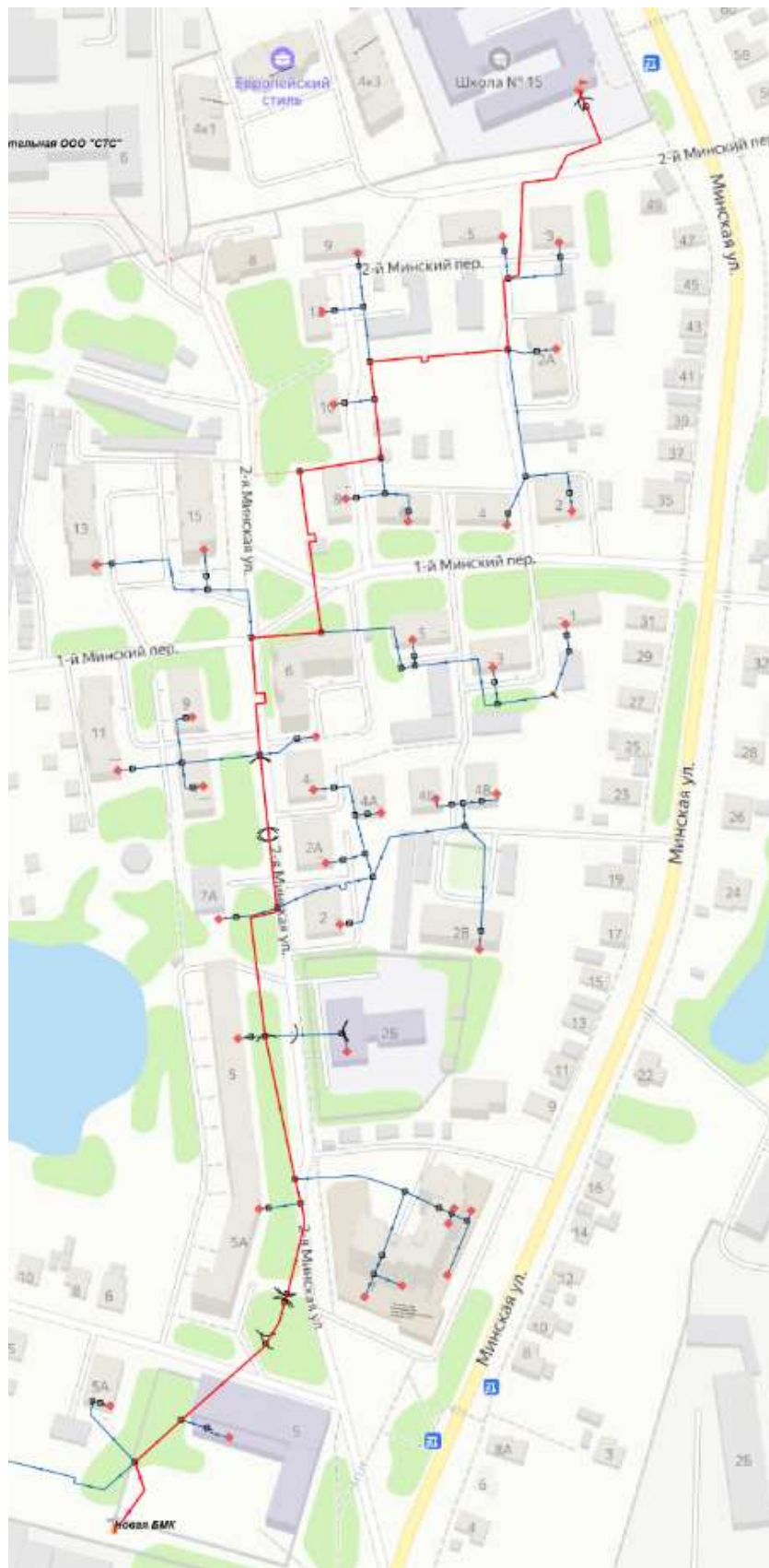
Рис. 3.58. Путь для построения пьезометрического графика участка тепловой сети от новой БМК до потребителя по ул. Минская, 53
