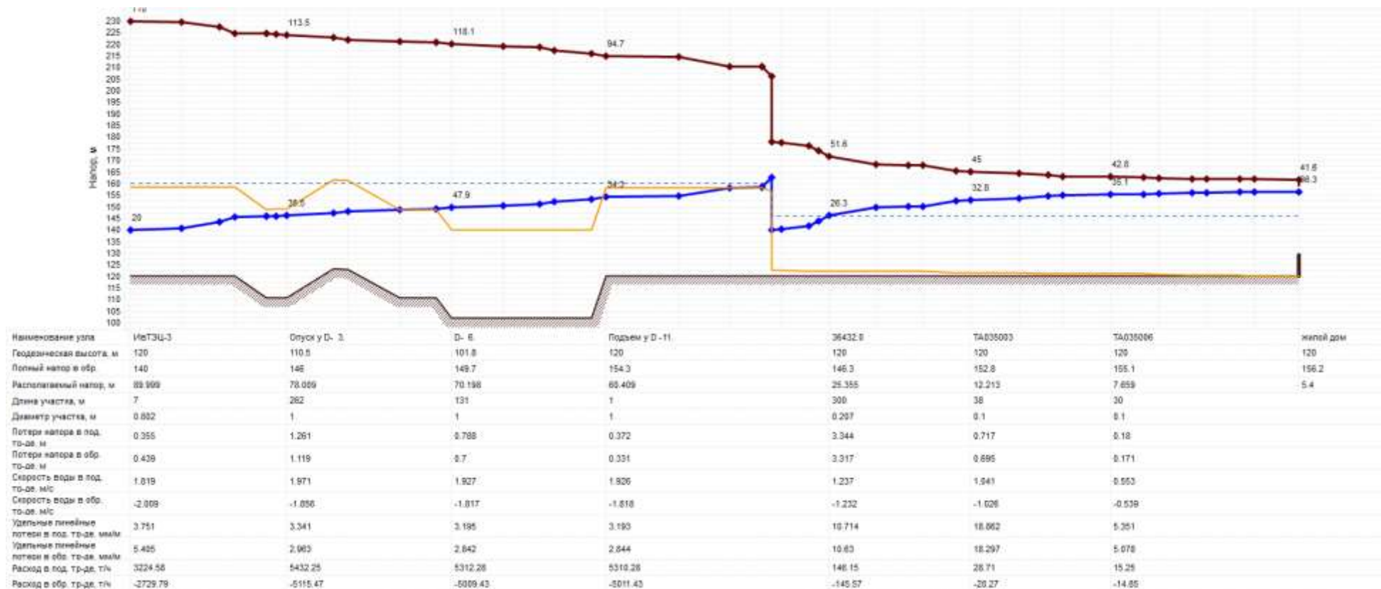
Рис. 3.37. Пьезометрический график участка тепловой сети от ИвТЭЦ-3 в зону котельной ООО «ТДЛ-Энерго» до потребителя по адресу ул. 2-я Лагерная 53 (Сценарий 5)
