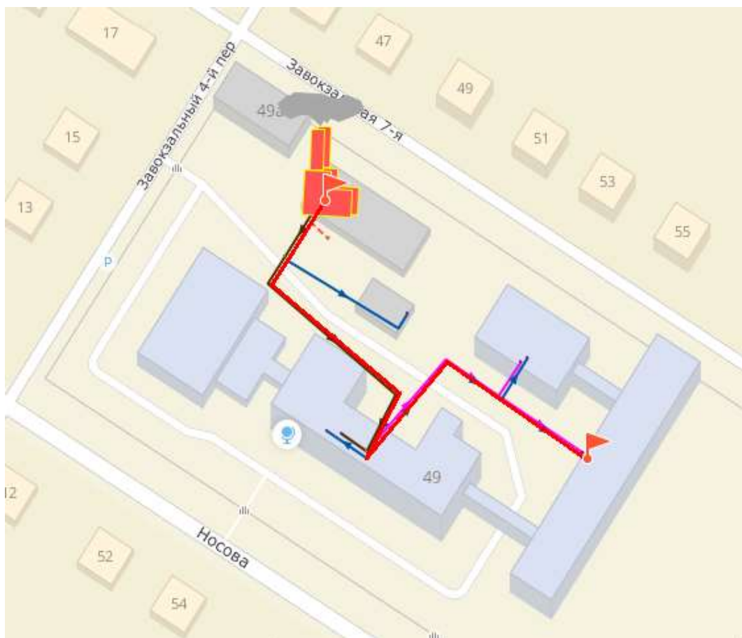
Рис. 5.15 Путь движения теплоносителя от источника тепловой энергии до конечного потребителя, в зоне действия котельной №24
