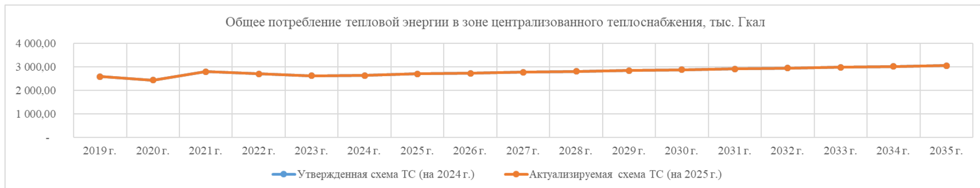
Рис. 1.6. Сравнение общего потребления тепловой энергии в зоне централизованного теплоснабжения актуализируемой (на 2025 г.) схемы теплоснабжения с утвержденной схемой теплоснабжения (на 2024 г.)
